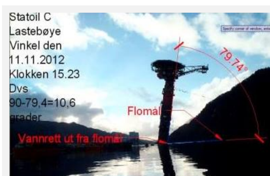
Figur 18: 79.74° tilting av Statfjord C lastebøye
